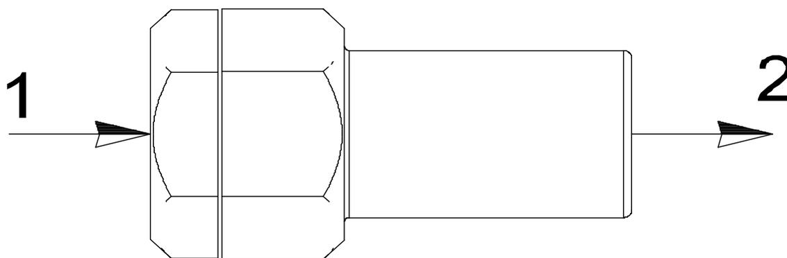
A válvula unidirecional permite a passagem de ar , unicamente , no sentido do fluxo indicado, de "1" para "2".
