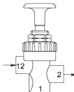
Quando a pressão em "1" for zero, ao pressionar o manípulo, permite a passagem do ar de "12" para "2", realimentando a linha de emergência do veículo, liberando-o quando desacoplado do veículo trator.
