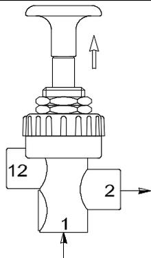
Quando pressurizado em "1", permite a passagem de ar para "2".
